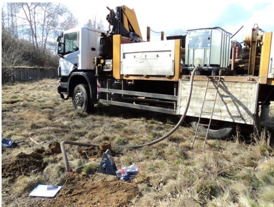
Obr. 1. Realizace vsakovací zkoušky dle ČSN 75 9010
