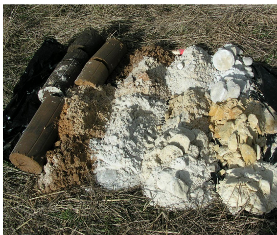
Obr. 8. Vrtné jádro z kaolinických pískovců a vsakovací tunely umístěné v těchto pískovcích
