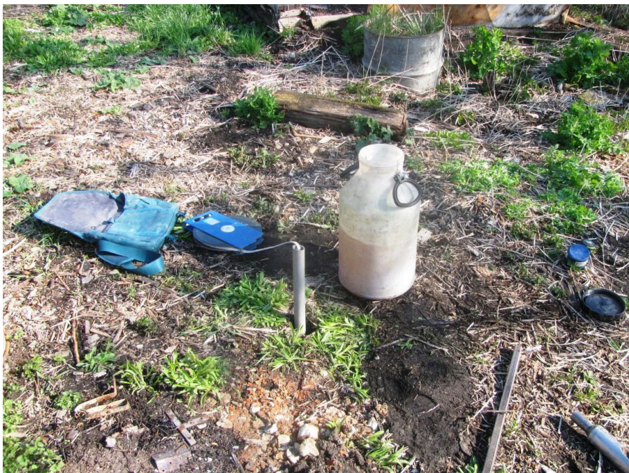
Obr. 2. Realizace vsakovací zkoušky v penetrační sondě
