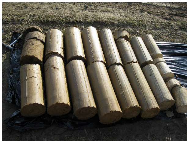
Obr. 9. Tvar i lesk vrtného jádra naznačují skutečnost, kterou potvrdily vsakovací zkoušky
